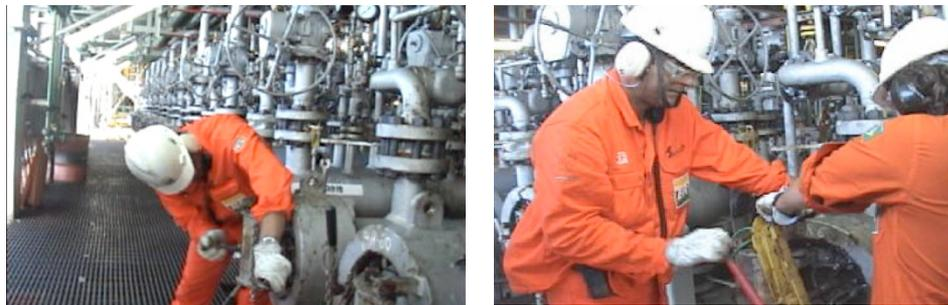
Figure 3 : Fermeture du portillon du système de PIG – Source : Remiro, 2009
