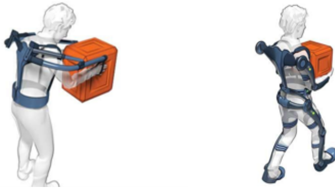
Schématisme des différents dispositifs d'assistance physique et illustration de deux types d'exosquelettes (de gauche à droite) : membres supérieurs et corps entier 97 .
