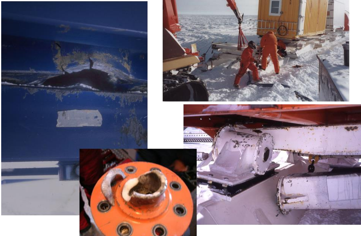
Des casses surviennent, en particulier lors des démarrages lorsque la force de traction est forte (© photos Villemain et Godon)
