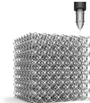
Figure 9- Réalisation de pièces complexes sans soudures ni assemblages
