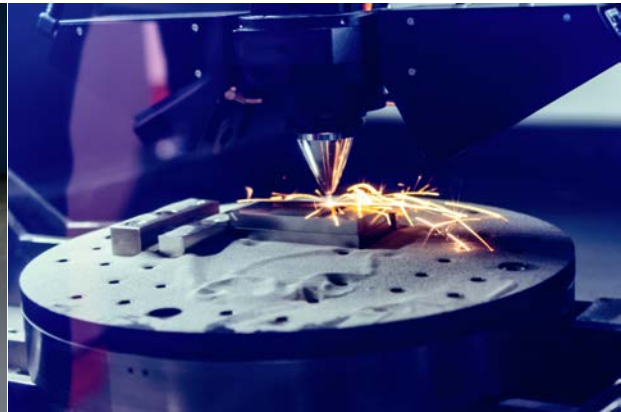
Figure 12- Fusion de poudre projetée (BEAM)
