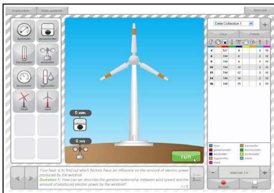
Figure 4: Prototype d'un « monde » simul , ici un moulin   vent dans un environnement d fini par diff rentes variables. Les  tudiants doivent trouver le lien entre ces diff rents facteurs environnementaux (p. ex. vent, temp rature, pression d'air), les propri t s du moulin   vent (p. ex. nombre de pales, hauteur du m t) et la production de puissance  lectrique r sultante.
