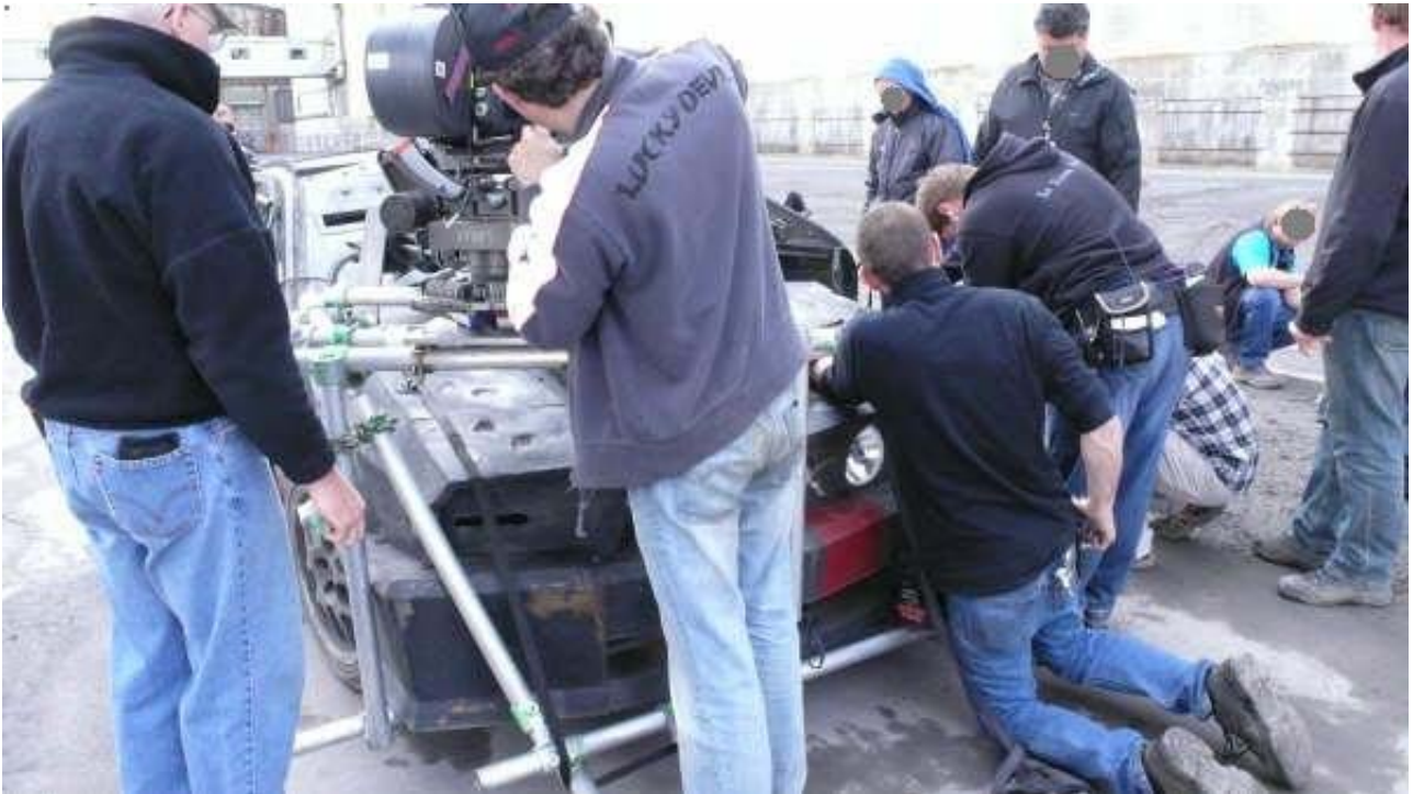
Machinistes au montage d'une caméra-car
